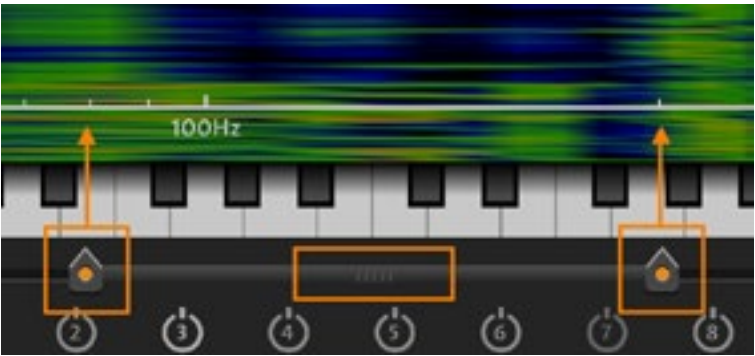
Figure 10 - Contrôles partagés par le spectrogramme et le graphique
