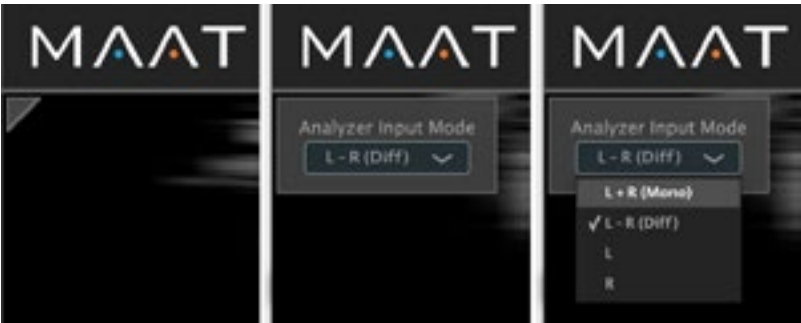
Figure 9 - Le menu d'entrée de l'analyseur : Passer la souris, cliquer et sélectionner
