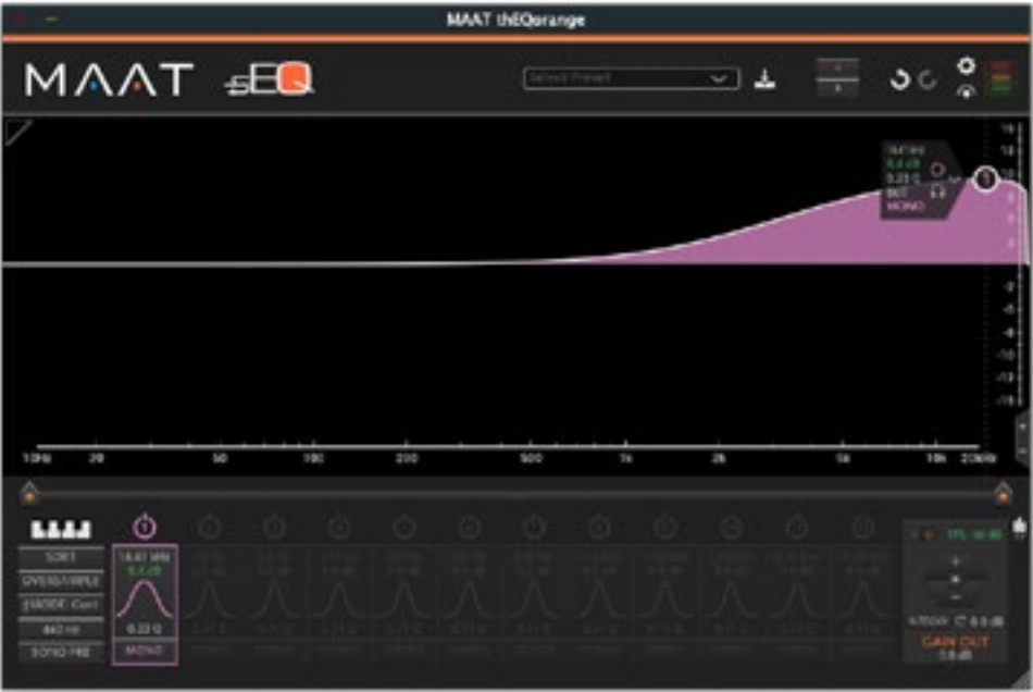
Figura 3: A velocidades de muestreo de banda base, puede producirse deformación de frecuencias
