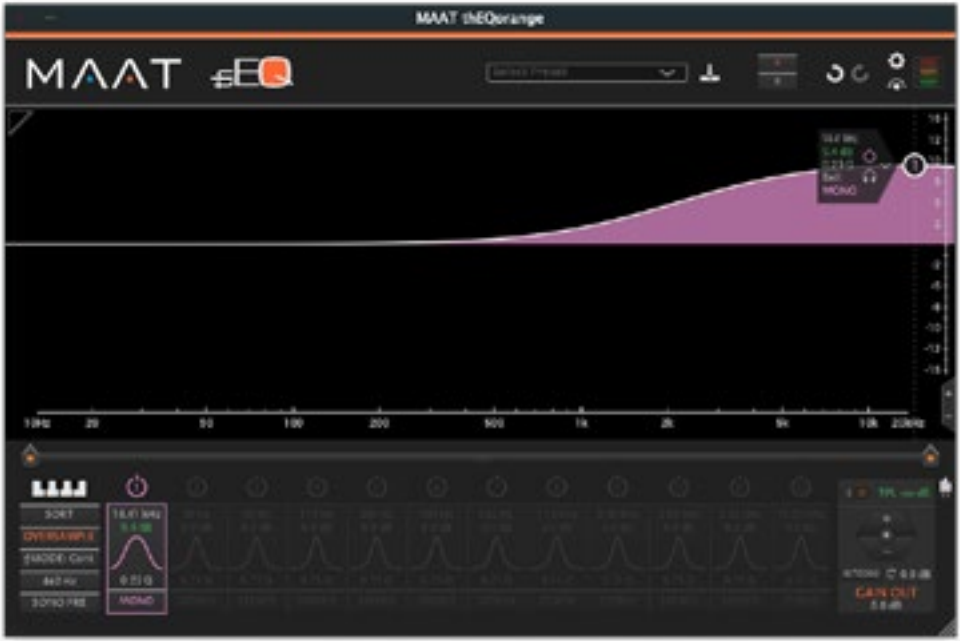
4：オーバーサンプリングを有効にしたベースバンドでは、周波数ゆがみが解消される
